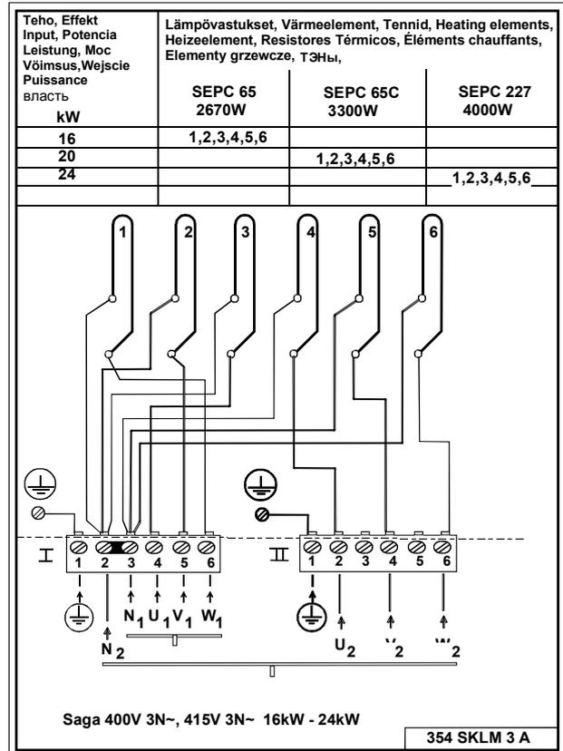
Рис. 4. 2 группы мощности 400V-415V 3N~ 16 кВт - 24 кВт
